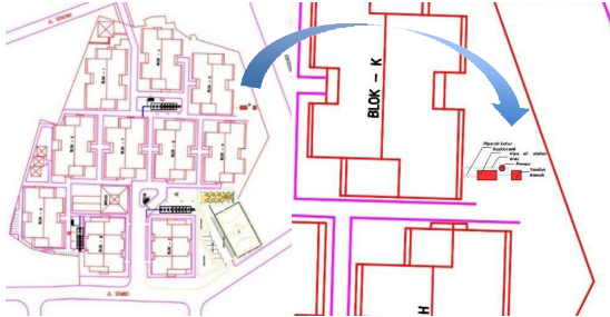
Gambar 5. Usulan Lokasi Peletakan IPAL Sederhana Sesuai Lokasi di Area Rusunawa yang Masih Memungkinkan Sumber: Olahan Penulis, 2024
