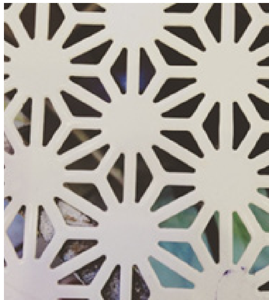
Gambar 11. Pola Plat Besi dengan Teknologi Laser Cutting yang Digunakan Sebagai Top Table Pada Kafe di Stasiun Gambir Jakarta. (sumber : Amarena, 2015)
