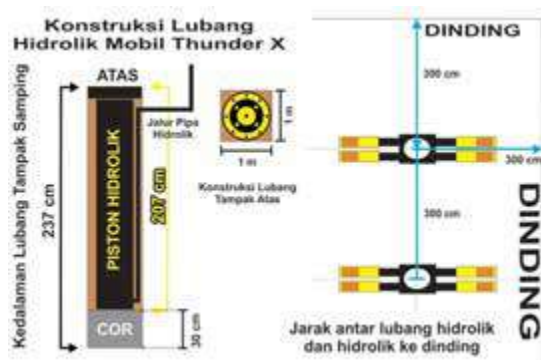
Gambar 7. Konstruksi Lubang Hidrolik Sumber: Istana Carwash, 2017
